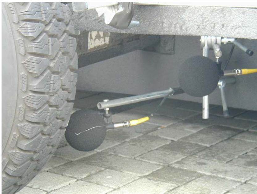
Abbildung 4. Reifen D mit Messmikrofonen (MP 4 und MP 1)
