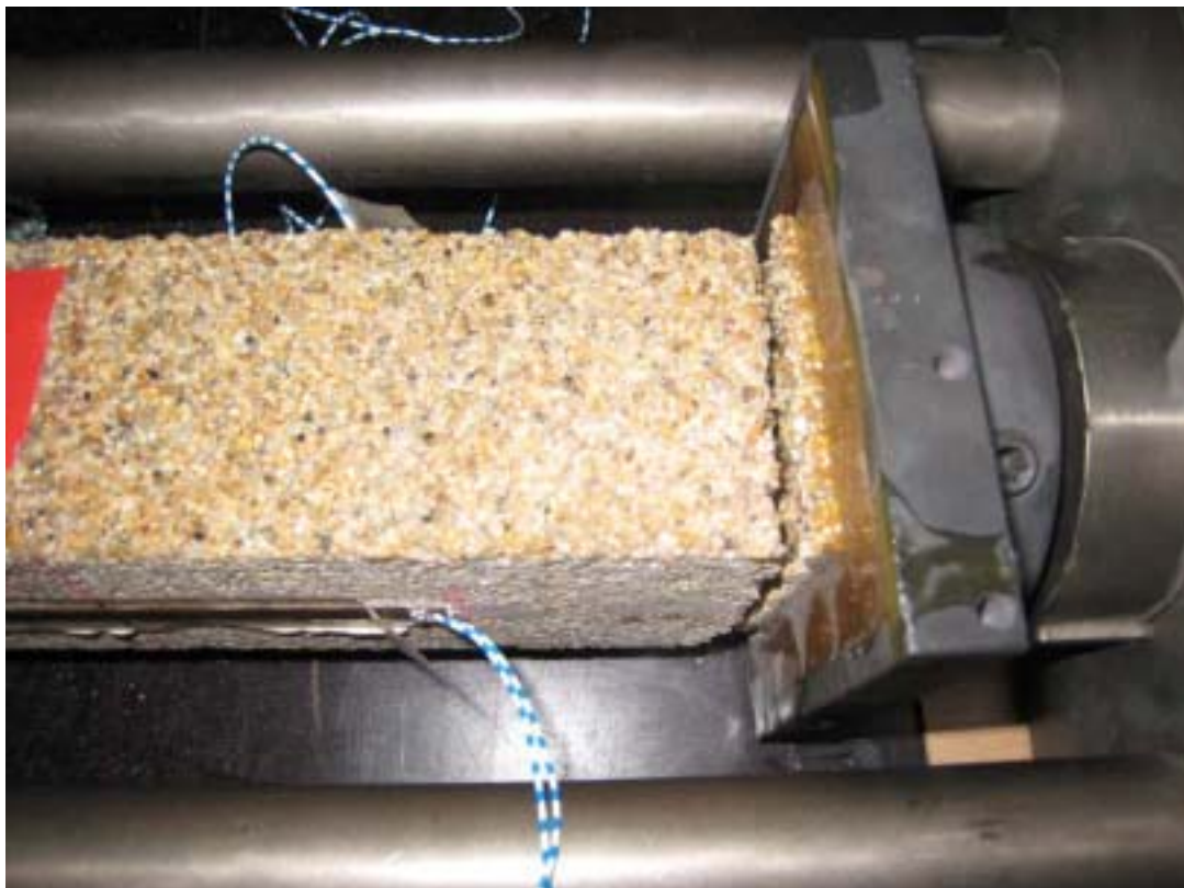
Bild 8: Zugbruch des Balkens nahe bei der Einbindung zur Versuchseinrichtung. Infolge der Querschnittsänderung wirken hier zusätzliche Spannungen. Die ermittelte Zugfestigkeit liegt somit „auf der sicheren Seite“.
