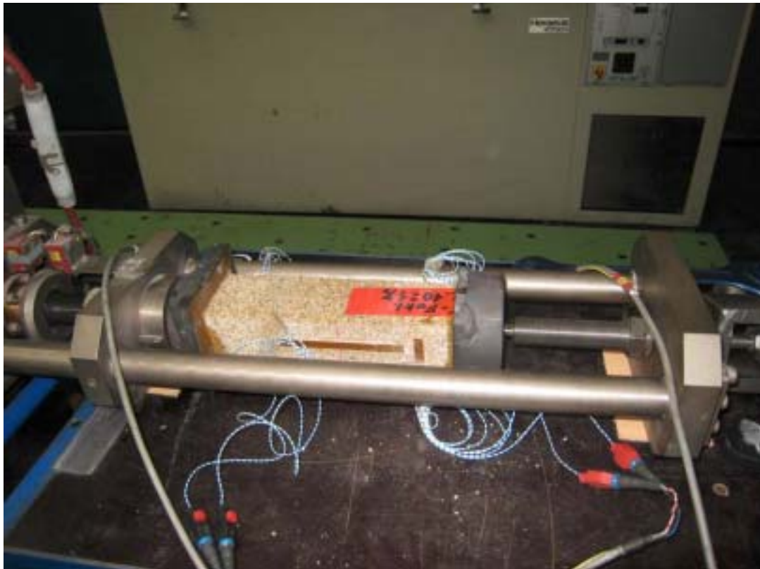
Bild 7: Versuchsaufbau des einaxialen Zugversuchs an Deckschichtbalken.
