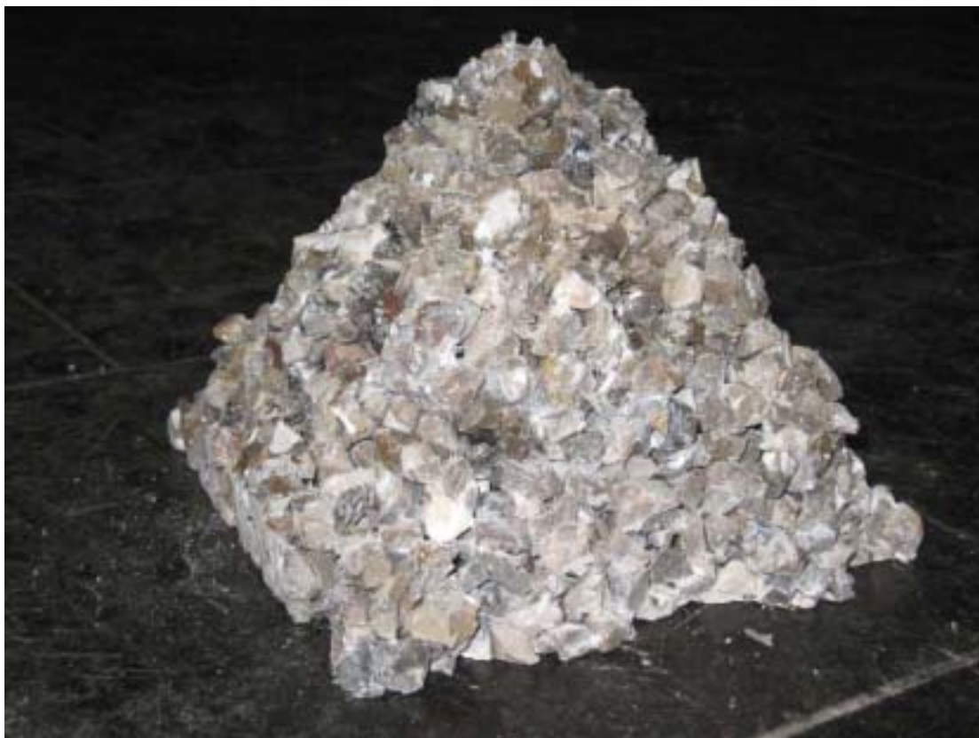
Bild 4: Bruchkegel des Probewürfels. Die Bruchfläche zeigt hauptsächlich Gesteinsbrüche. Die Form beschreibt ein „zerbersten“ der Probe.
