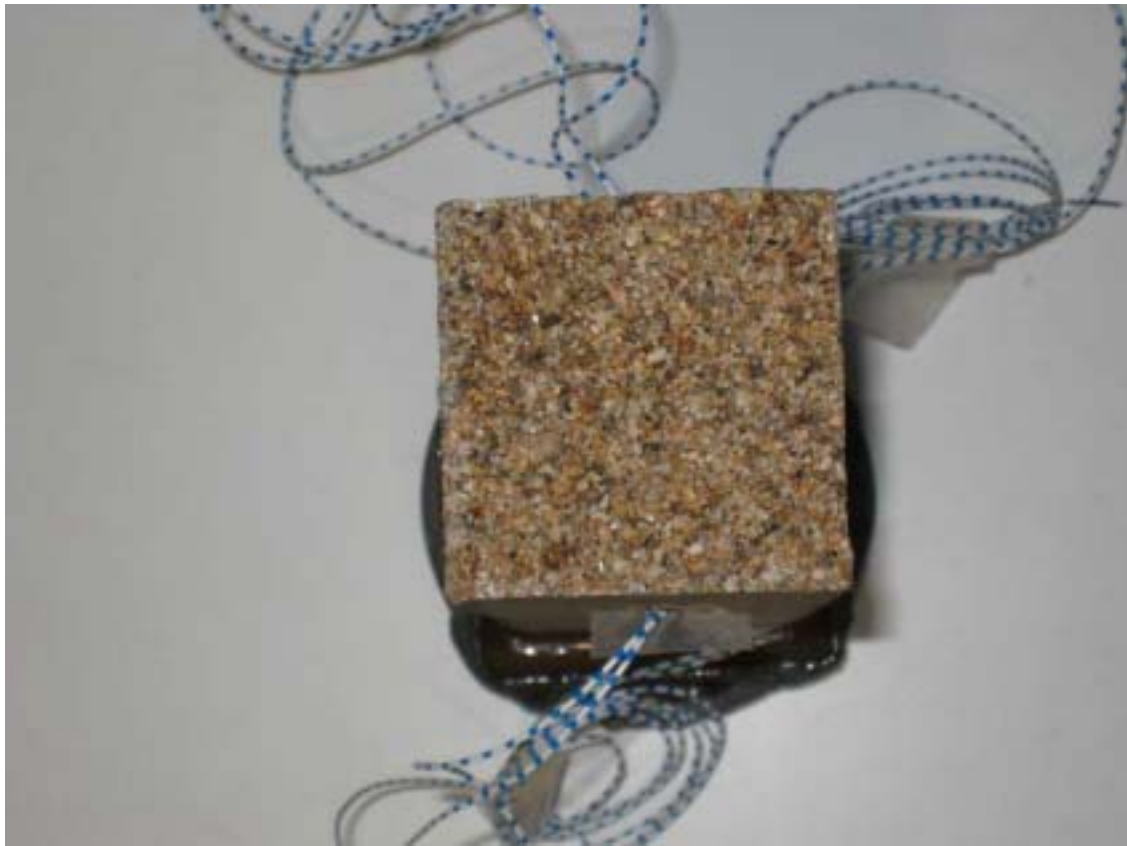
Bild 9: Bruchfläche eines Probekbalkens der Deckschicht nach dem Zugversuch.
