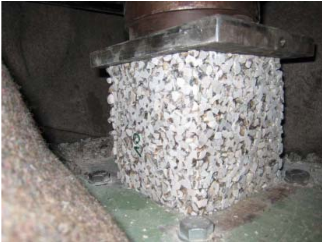
Bild 3: Probewürfel (Kantenlänge: 150 mm) bei der Bestimmung der Würfeldruckfestigkeit.
