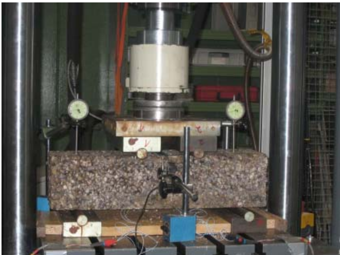
Bild 10: Aufbau des Biegeversuchs mit 2-Punkt-Lasteintragung.
