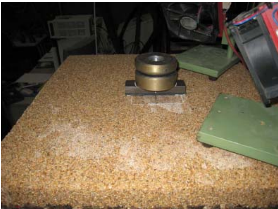
Bild 14: Lastfläche (30 x 120 mm) mit Gummiunterlage zur Simulation der Belastung durch Staplerbereifung.
