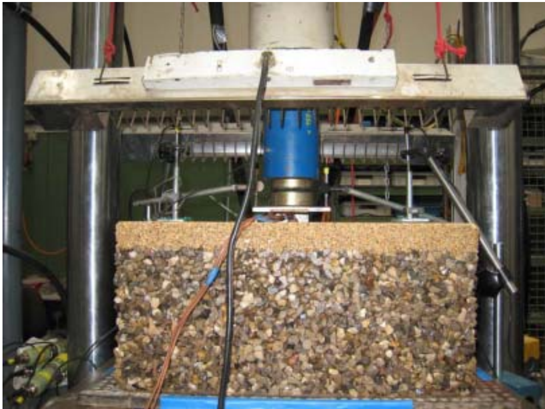
Bild 15: Dauerstandversuch mit zusätzlicher Temperaturbelastung.
