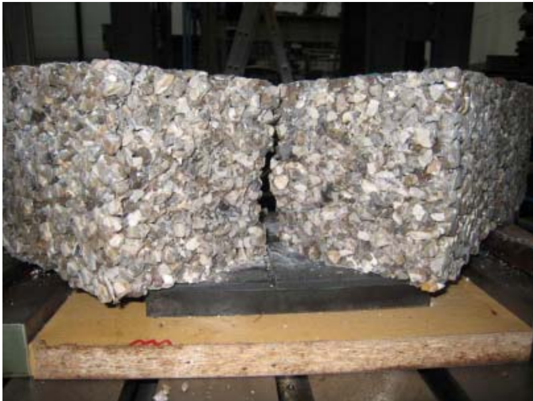
Bild 11: Bruchfläche des Biegebalkens mit hauptsächlich Gesteinsbrüchen.
