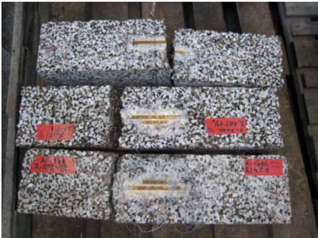
Bild 12: Probekörper mit applizierten Dehnungsmessstreifen nach Ermittlung der Biegezugfestigkeit.
