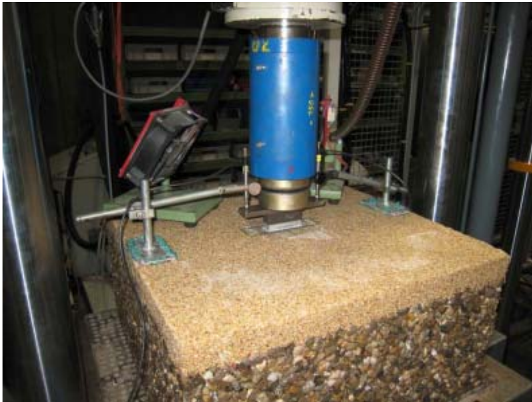
Bild 13: Versuchsaufbau im Dauerstandversuch an zweischichtigem Oberbau. Die kleine Lasteintragungsfläche (20 x 60 mm) aus Hartkunststoff simuliert die Beanspruchung durch „Ameise“ mit hohen Kontaktspannungen.
