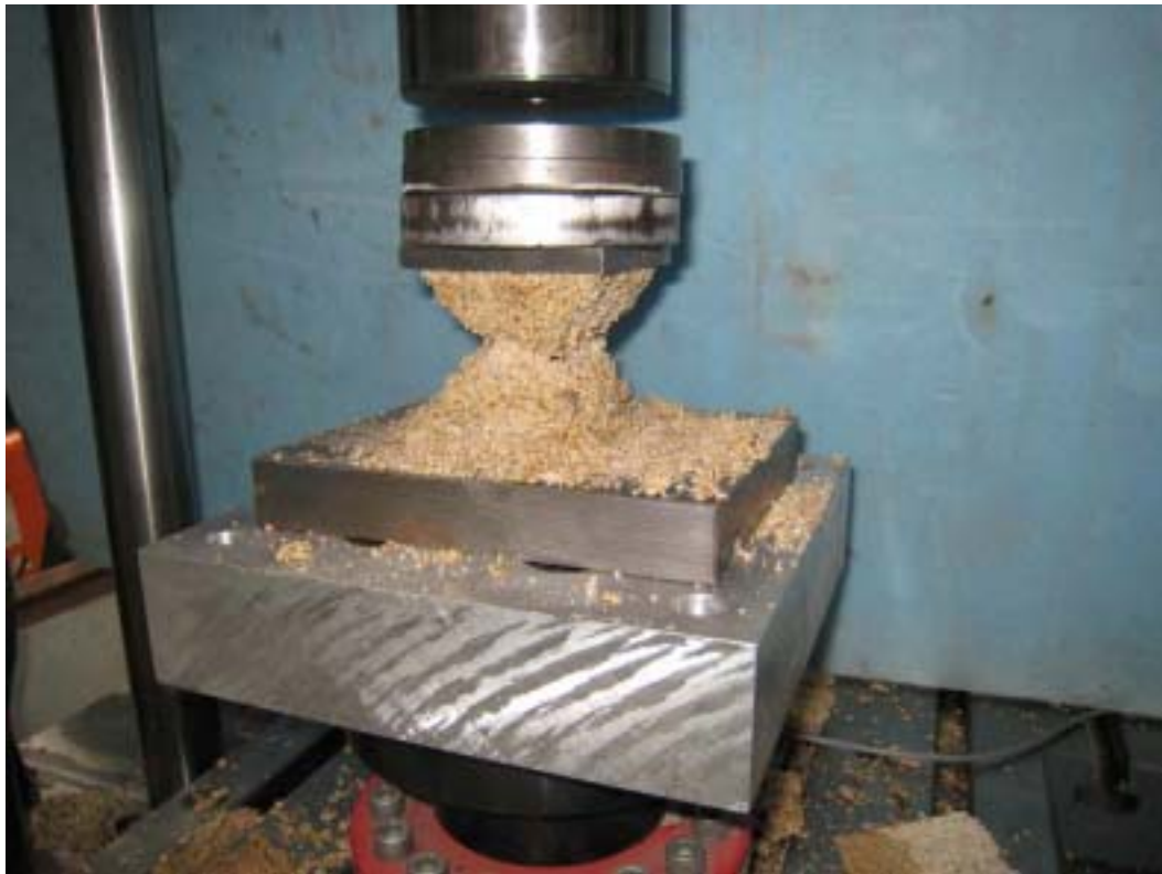
Bild 5: Form des Bruchkörpers der Deckschichtprobewürfel (Kantenlänge 88 mm).
