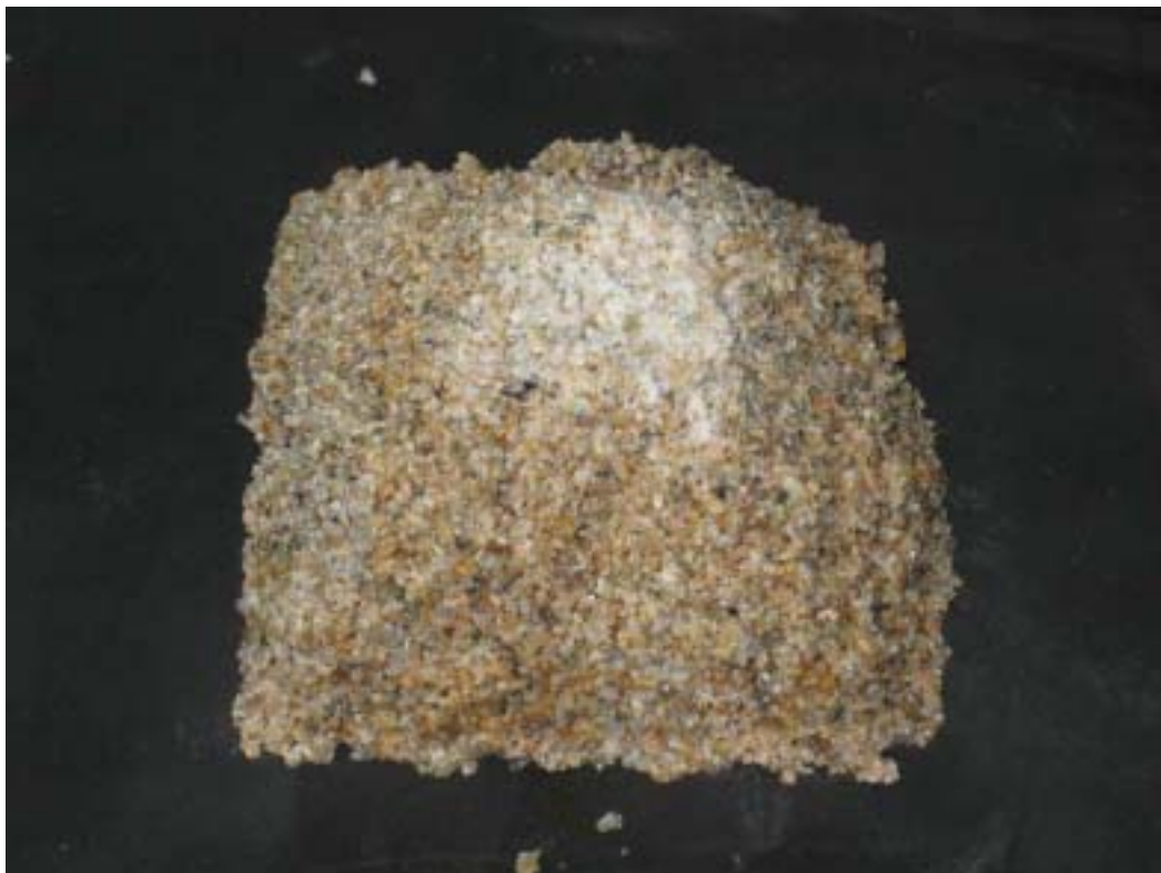
Bild 6: Der Bruchkegel zeigt „im Kern“ zermalmte Gesteinskörnung. Die feine Körnung 1/3mm erlaubt keine präzise Aussage zur Art des Bruchs.
