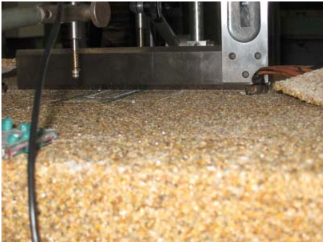
Bild 16: Oberfläche des Probekörpers mit minimalen Deformationen (0,1 mm) nach Dauerstandversuch mit Temperaturbelastung.
